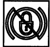
Quando el camión esté completamente detenido y en posición de carga, aplique el bloqueo de freno presionando la parte superior del interruptor oscilante. Para liberar el freno, presione la parte inferior del interruptor oscilante.
