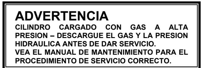
Esta placa de peligro va en las cuatro suspensiones. Contiene instrucciones para liberar la presión interna antes de desconectar algún accesorio. Si no se siguen estas instrucciones se pueden producir serias lesiones.
