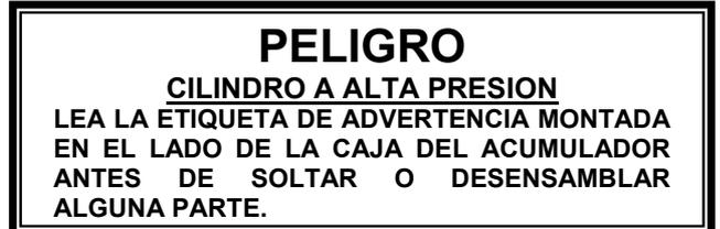
Estas calcomanías de advertencia van montadas al lado de cada uno de los acumuladores (tanto de dirección como de freno) para alertar a los técnicos que descarguen todo el gas y la presión hidráulica, y para que lean el manual de mantenimiento/servicio antes de realizar algún servicio.
