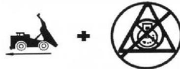
1. El interruptor permite al operador anular el interruptor límite de subir tolva y mover el hacia delante camión cuando la palanca de control direccional está en AVANCE, la tolva está levantada y los frenos están liberados.
