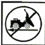
**El camión no se debe mover con la tolva levantada excepto en casos de emergencia. No bajar la tolva antes de mover el camión podría dañar los cilindros de elevación, el bastidor y/o los pasadores de la bisagra.**
