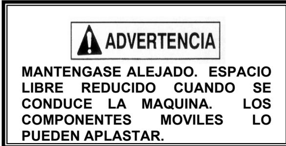
Las placas de advertencia están adheridas tanto al estanque hidráulico como al estanque de combustible para alertar a los técnicos de que no deben trabajar en el camión con la tolva levantada a menos que el dispositivo de retención subir tolva (pasadores o cable) esté en su posición.
