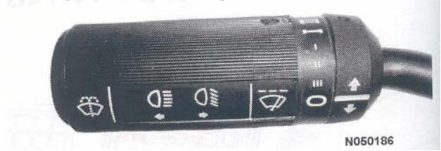
El interruptor de señal de viraje multifuncional (4, Figura 32-2) se usa para activar las luces de señalización de viraje, los limpiaparabrisas y para seleccionar luces altas o bajas.
