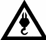
PARA UN LEVANTE SEGURO DE LA CAJA DE REJILLA, SE DEBEN USAR 4 CABLES (UNO CONECTADO A CADA PUNTO DE LEVANTE). TODOS LOS CABLES DEBEN IR A UN MISMO PUNTO. TODOS LOS CABLES DEBEN SER IGUALES, Y TENER ENTRE 7.5 (2.3) Y 15 PIES (4.6 mm) DE LARGO. NO SE DEBE CONECTAR NINGUN OTRO EQUIPO A LA CAJA DE REJILLA AL LEVANTAR. EL PESO DE LA CAJA DE REJILLA ES DE 5900 LBS. (2676 KG).
