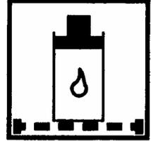
*NOTA: La luz de advertencia del monitor del filtro puede también encenderse después de arrancar el motor si el aceite está frío. Si la luz se apaga después que se calienta el motor, no se necesita mantenimiento del filtro.*
