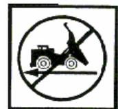
***El camión no se debe mover con la tolva levantada excepto en casos de emergencia. No bajar la tolva antes de mover el camión podría dañar los cilindros de elevación, el bastidor y/o los pasadores de la bisagra.***
